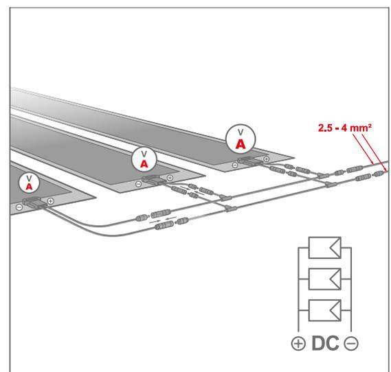
Darüber hinaus müssen bei der Kabelauslegung der Verbindungskabel die Gesamtströme unter Berücksichtigung der maximalen Umgebungstemperatur und des Kurzschlussstroms  $I_{sc}$  einschließlich seines Temperaturkoeffizienten und/oder eines Sicherheitsfaktors von 1,25 berücksichtigt werden.
