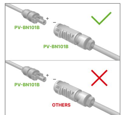
Für den Einsatz in Solaranlagen müssen als Anschlusskabel geeignete Kabel mit einem Leiterquerschnitt von 2,5 mm<sup>2</sup> bis 4 mm<sup>2</sup> verwendet werden, die den Umgebungsbedingungen, der Stromstärke und dem Systemspannungsbereich der jeweiligen Solarfolien entsprechen. Die zulässigen Leiterquerschnitte und Kabelaußendurchmesserbereiche des Steckertyps sowie die Montagehinweise der Steckerhersteller sind zu beachten.
