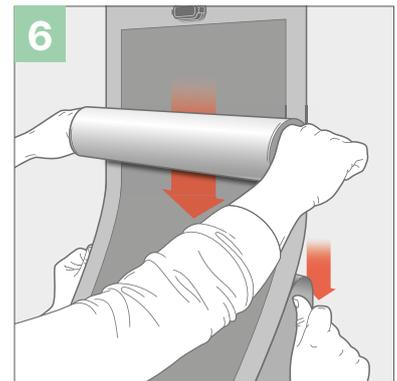
Wiederholen Sie Schritt 6, bis die Solarfolie vollständig fixiert ist. Achten Sie darauf, dass die Silikonrolle immer den ersten Kontakt der Solarfolie mit der Oberfläche herstellt. Vergewissern Sie sich, dass die Solarfolie gleichmäßig auf der Oberfläche fixiert ist, indem Sie die Silikonrolle über die gesamte Breite bewegen. Ihr HeliaSol ist einsatzbereit.
